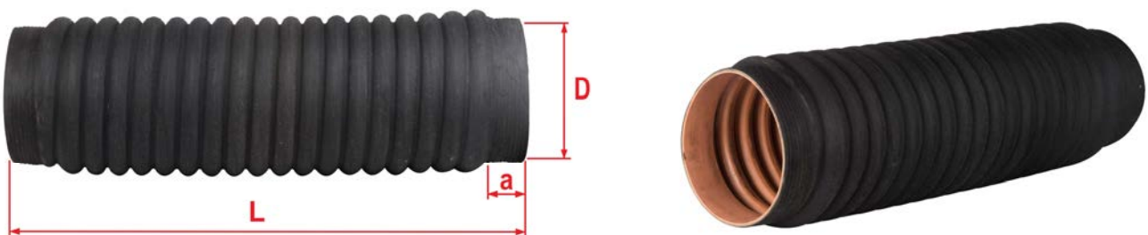
Hadice PROFILFLEX DN254 (vnitřní průměr D = 254 mm, celková délka L = 1 m, měkké konce bez spirály a vln a = 80 mm)
